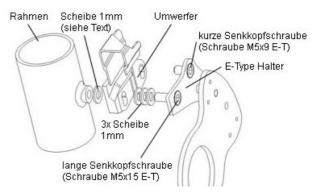
**4.:** Grundplatte des Kettenfängers mit rechter Lagerschale am Rahmen montieren. Die entsprechende Anordnung der Spacer ist der nachfolgenden Tabelle zu entnehmen. Die Lagerschale vorerst nur handfest anziehen.
